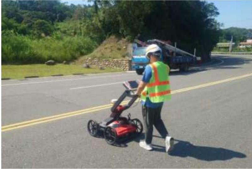
圖2-5 推車式透地雷達現場操作圖
