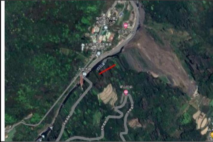
災害原因推估：強降雨導致地質破碎面持續崩落
