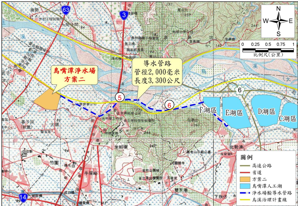
圖 4.3-4 人工湖至淨水場方案二導水管路線圖
