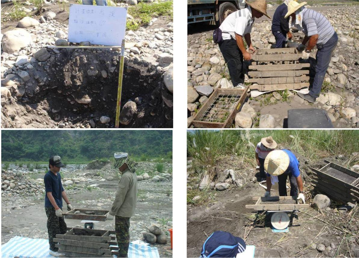
圖 3-1-6 河床質粒徑調查示意圖
