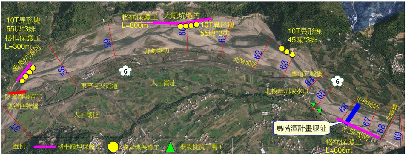
圖 2 河道中上游穩定工法佈置圖
