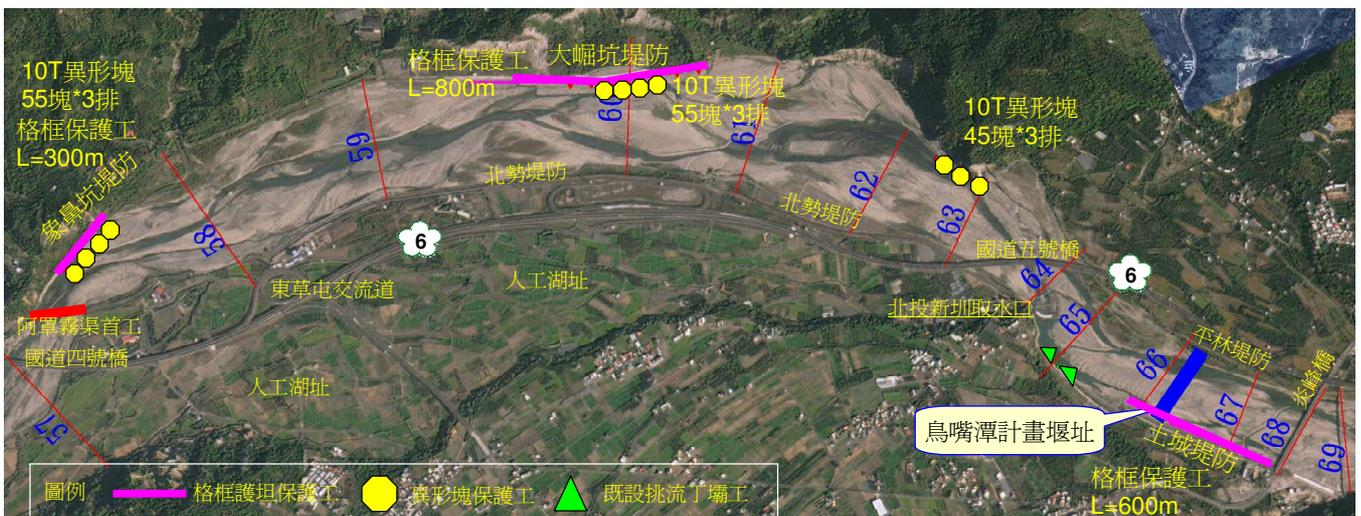
圖 6-3-2 河道中上游穩定工法佈置圖
