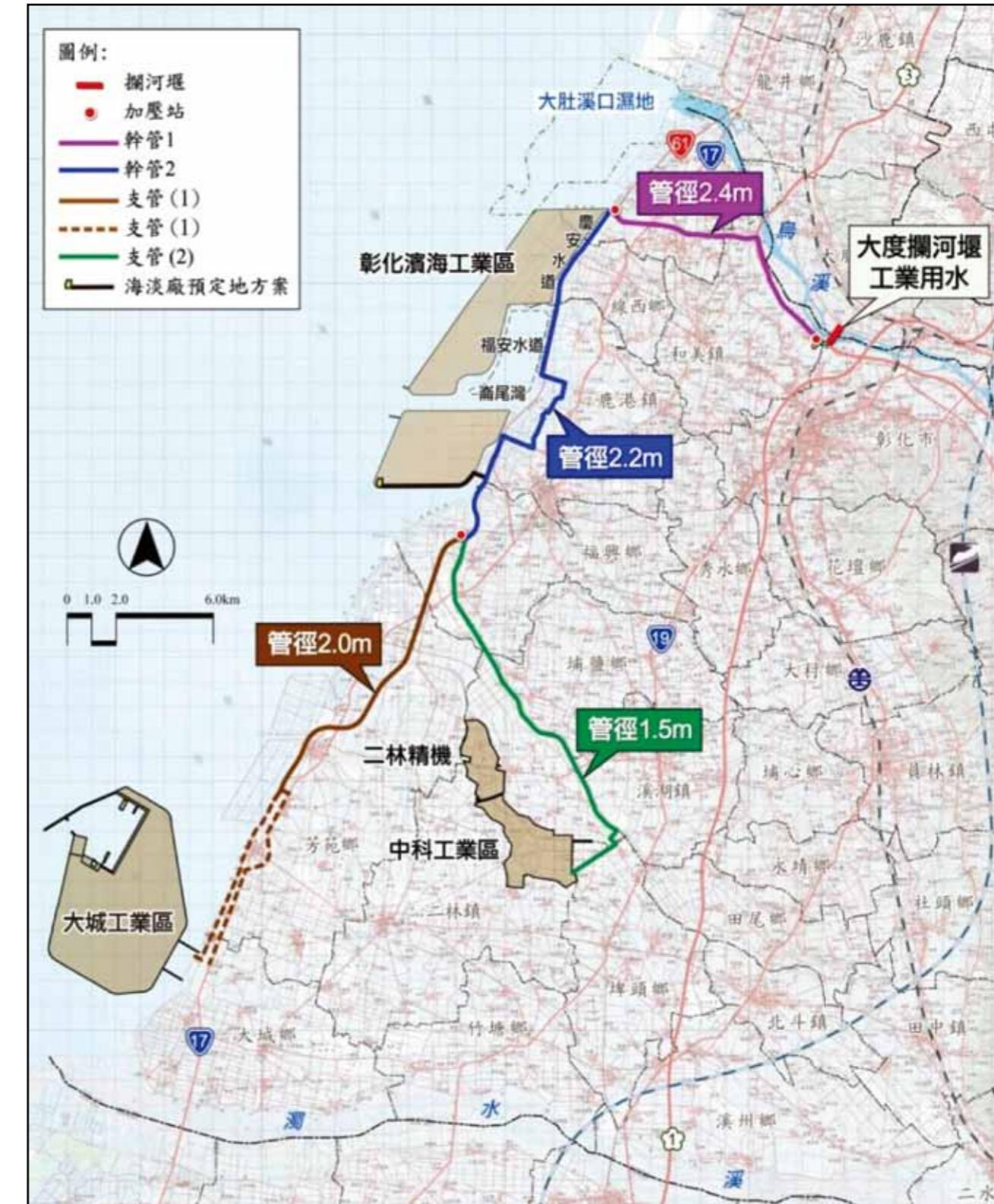
圖 11-7-1 大度堰工程計畫布置示意圖
