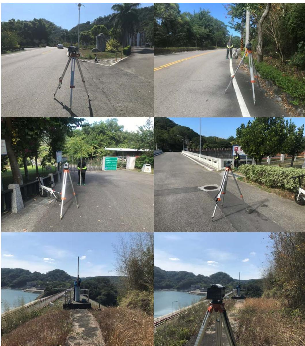
圖 5-3 直接水準測量工作情形照片
