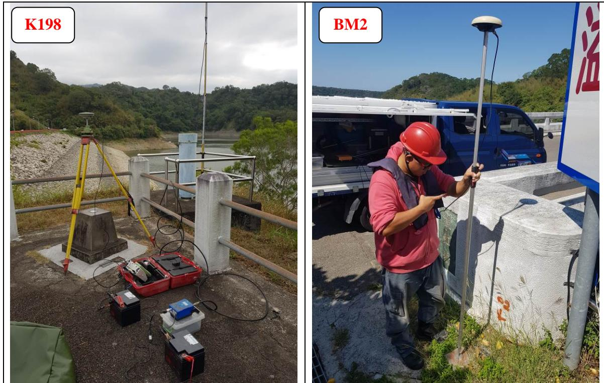
圖 5-12 水深測量 GNSS 陸上固定站架設情形
