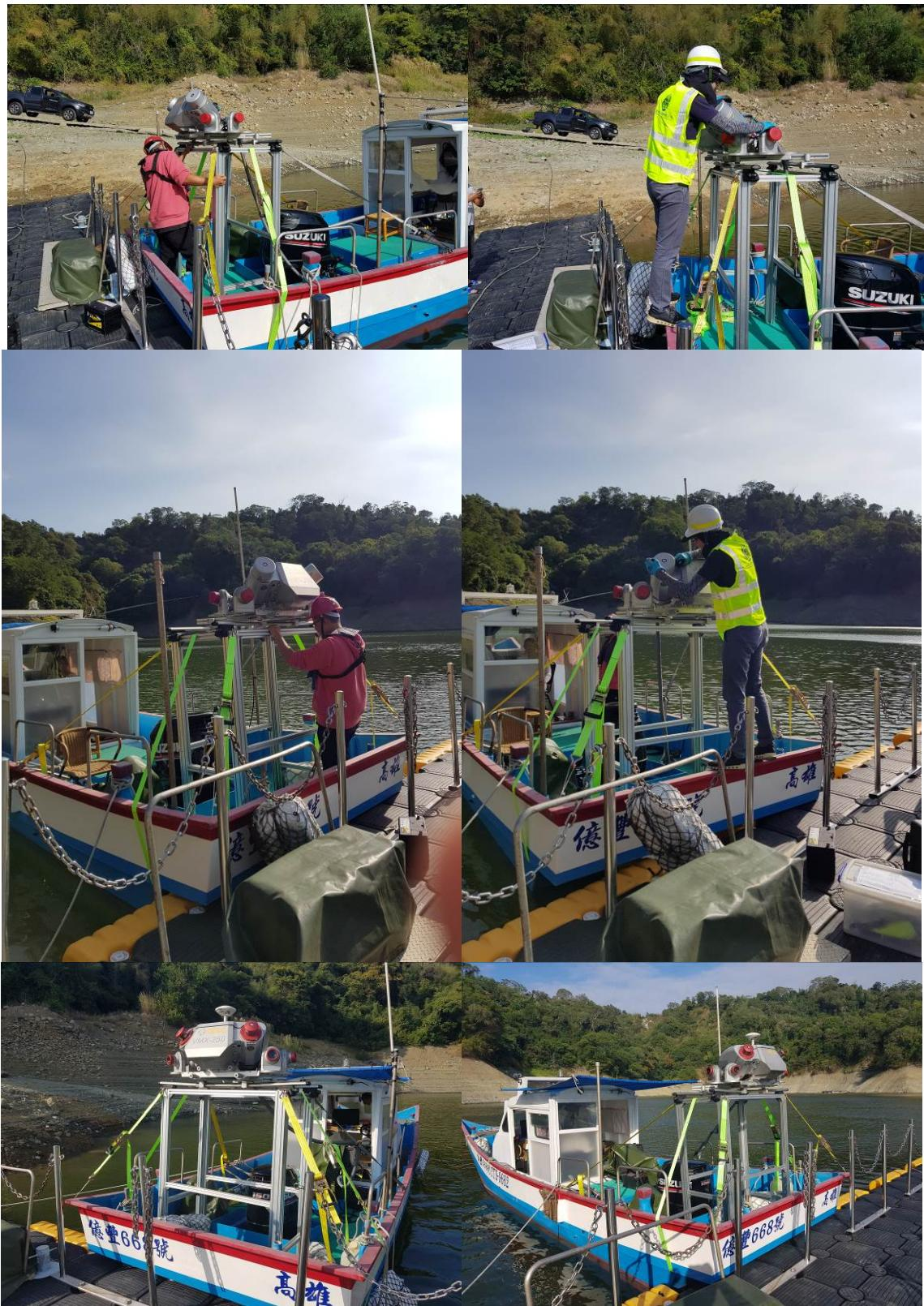
圖 5-26 本次作業行動雷射掃瞄工作照片
