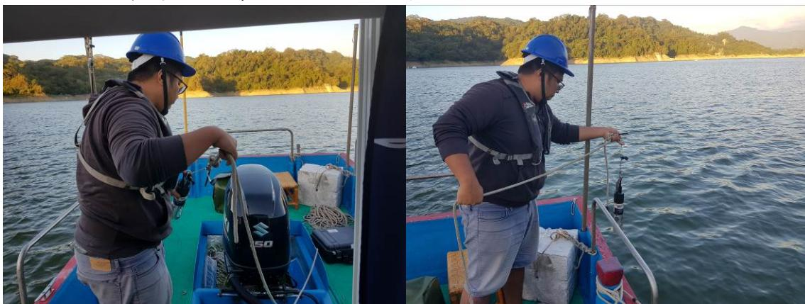
圖 5-15 聲速量測情形
