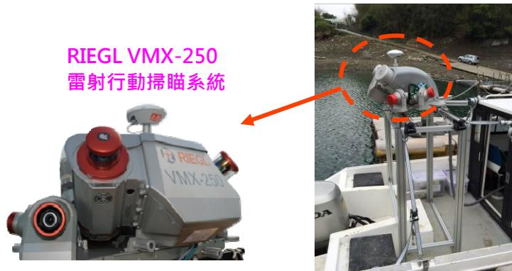
圖 5-24 RIEGL VMX-250 3D 行動雷射掃瞄系統船載安置情況
