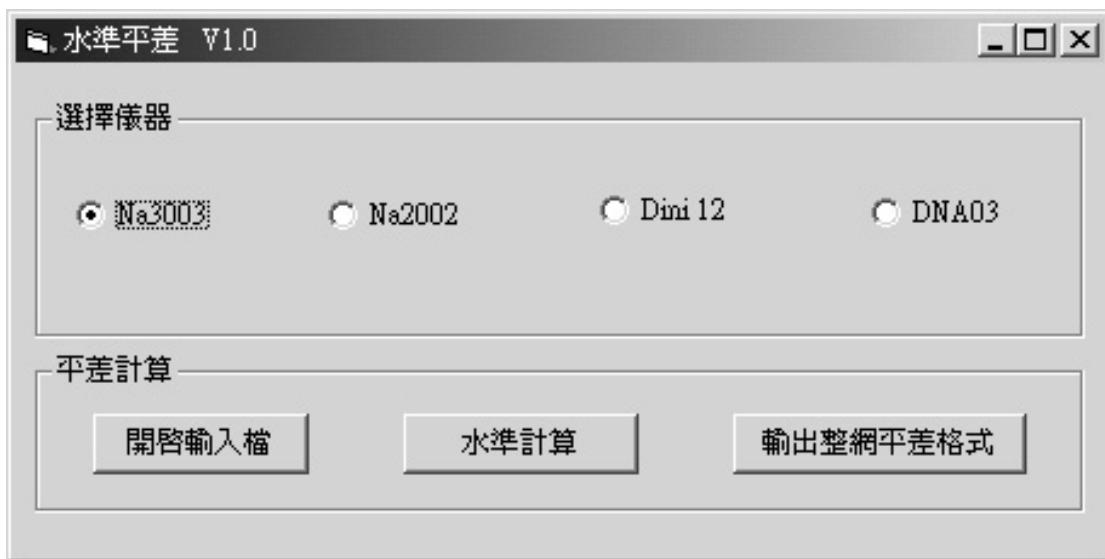
在選擇觀測資料輸入後，即會產生 \*.obs(觀測資料檔)及 \*.tab(觀測記錄表)等成果檔，另程式會依據水準測線數目之不同，而依序產生各條水準測線之計算檔(副檔名依 \*.A、\*.B、\*.C... 等順序排序)，再依序輸入各水準測線起迄點之高程，即可進行水準閉合平差計算，若水準測量有進行往返觀測，亦可一併計算出往返觀測閉合差。
