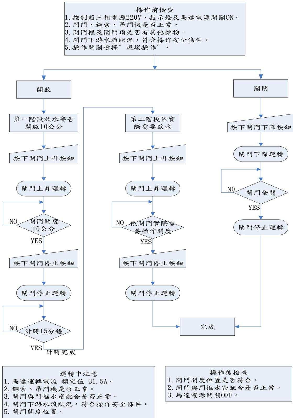
圖 3-2 後池堰操作維護流程圖
