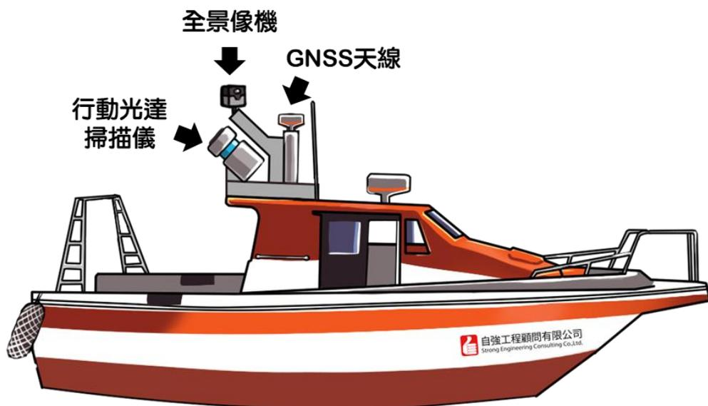
圖 5-30 RIEGL VUX-1-LR 行動式船載雷射掃描(範例)
