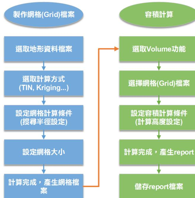
圖 5-38 容積計算流程
