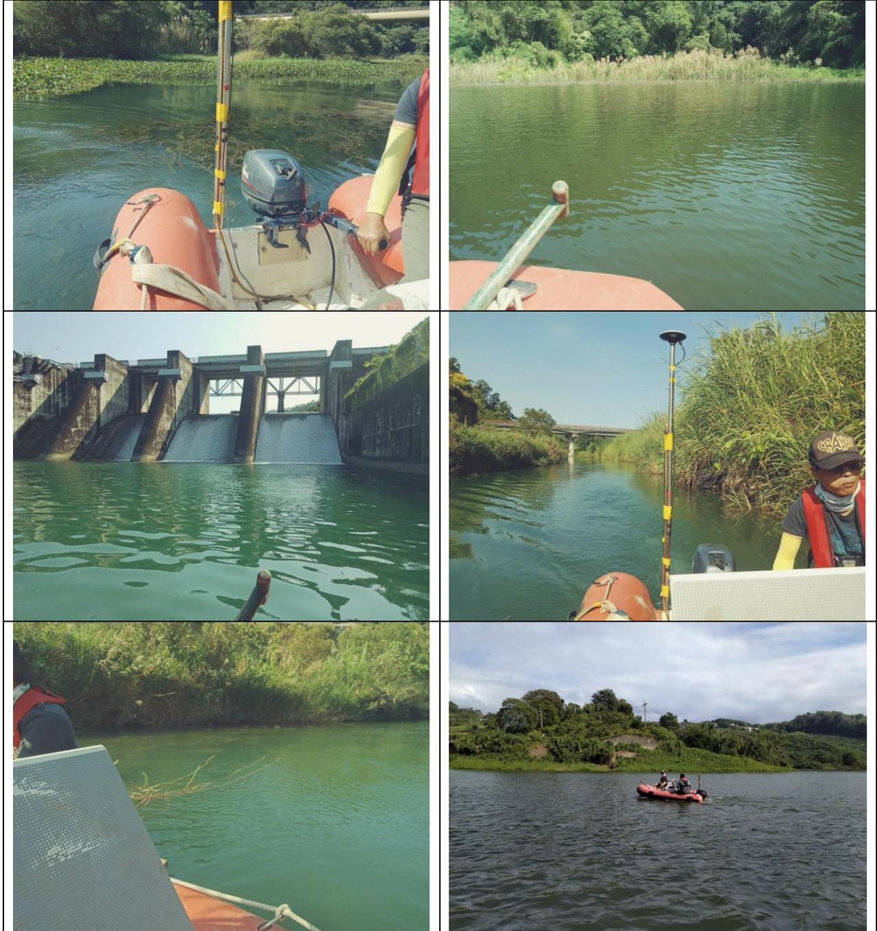
圖 5-29 單音束水深測量工作照
