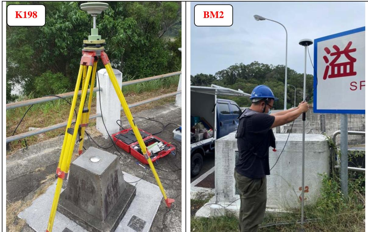
圖 5-15 水深測量 GNSS 陸上固定站架設情形
