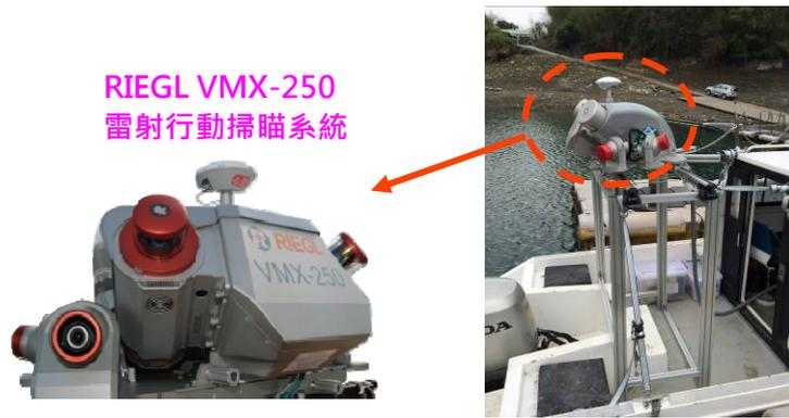
圖 5-26 RIEGL VMX-250 3D 行動雷射掃瞄系統船載安置情況
