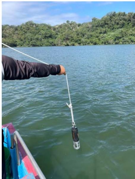
圖 5-17 聲速量測情形
