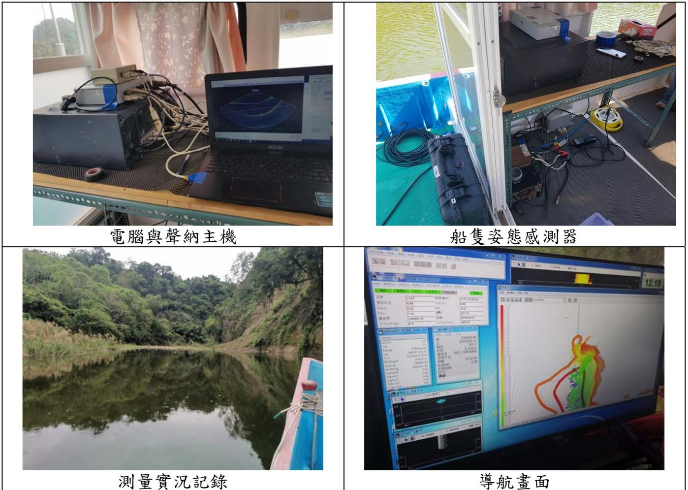
圖 4-3 水深測量儀器架設圖
