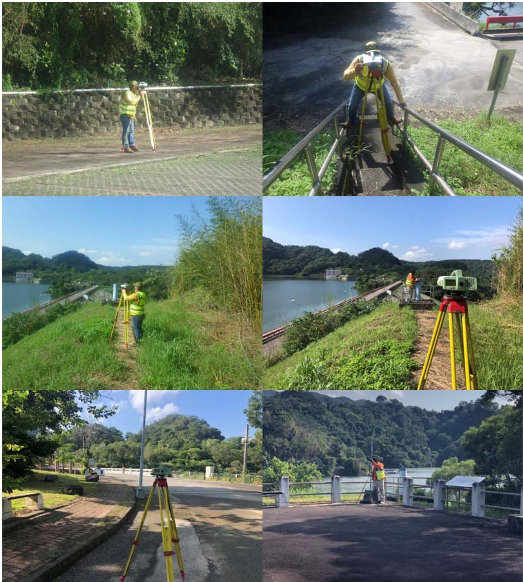
圖 5-6 直接水準測量工作情形照片
