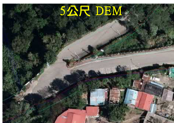
圖2-32 不同網格 DEM 正射影像糾正示意圖
