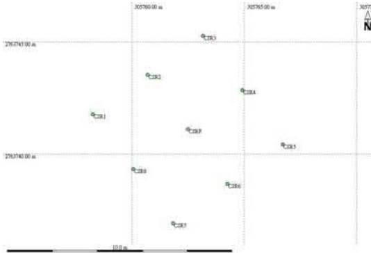
圖 1 超短基線校正場平面示意圖
