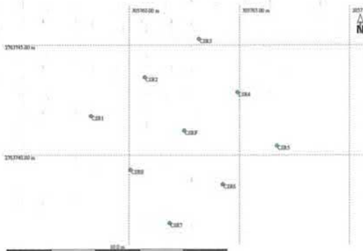
圖 1 超短基線校正場平面示意圖
