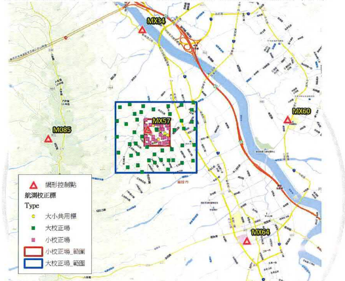
航空測量攝影機校正場位置及校正標分布
