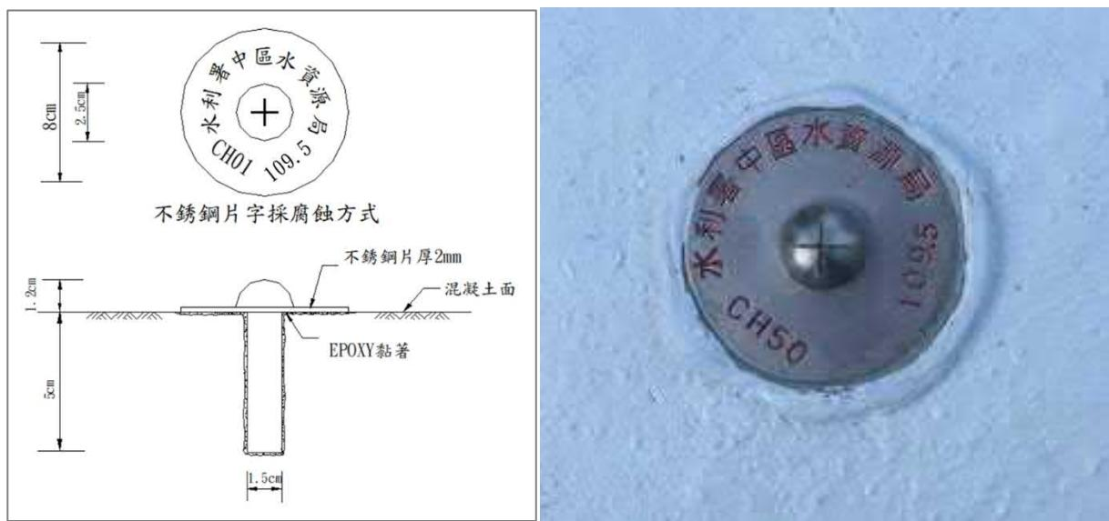
圖 2-4、航空標鋼樁加鋼片樁規格
