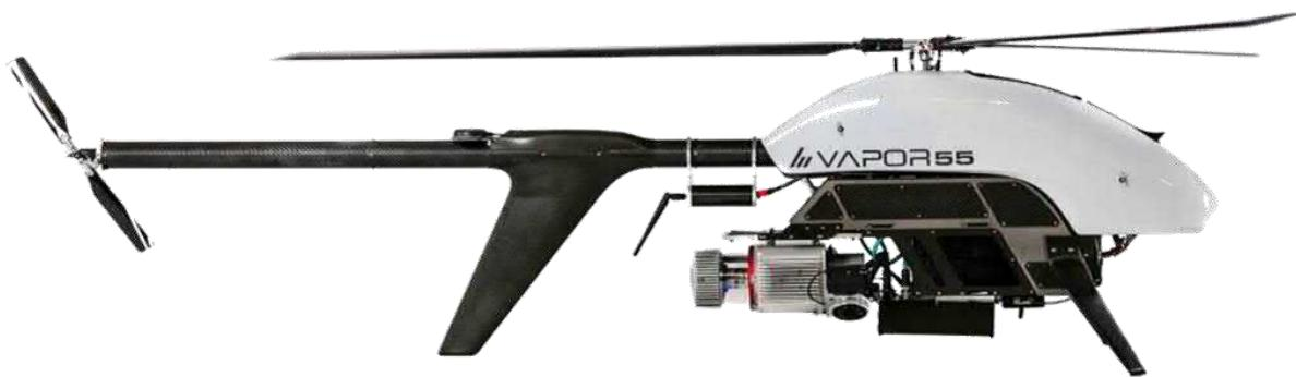
圖 2-11、直升機型無人飛機系統(VAPOR 55+RIEGL VUX1)
