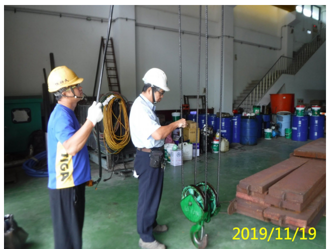
5. 108/11/19 倉庫 10t 吊車定期工檢
