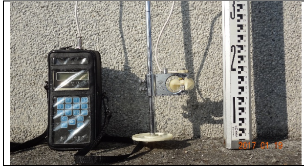
照片 2-1 重慶水文儀器廠製造的 LS45-2 型旋杯式流速儀
