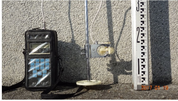
照片 2-1 重慶華正水文儀器廠製造的 CQS.LCY-1 型旋杯式流速儀
