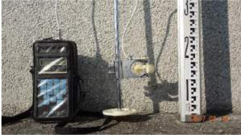
照片 2-1 重慶華正水文儀器廠製造的 CQS.LCY-1 型旋杯式流速儀
