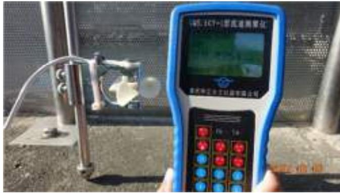
照片 2-1 華正水文儀器廠製造的 CQS.LCY-1 型旋杯式流速儀
