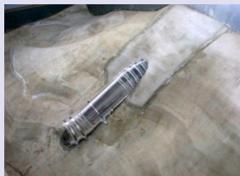
▲ 曾文水庫新增防淤隧道 1/32 局部模型試驗 (2012~2013 年)
