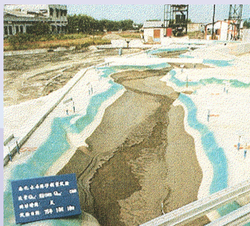
▲南化水庫空庫排砂模型試驗 (1985~1988 年)
