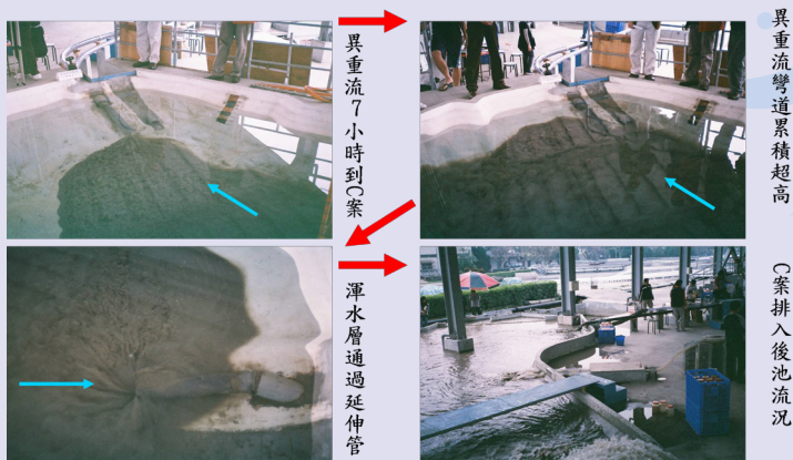
▲測試石門水庫大灣坪防淤隧道具象鼻防淤鋼管功能 (2010 年)
