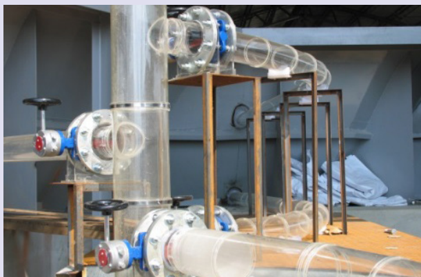
▲分層取水工程 1/21 局部模型照片 (2008 年)
