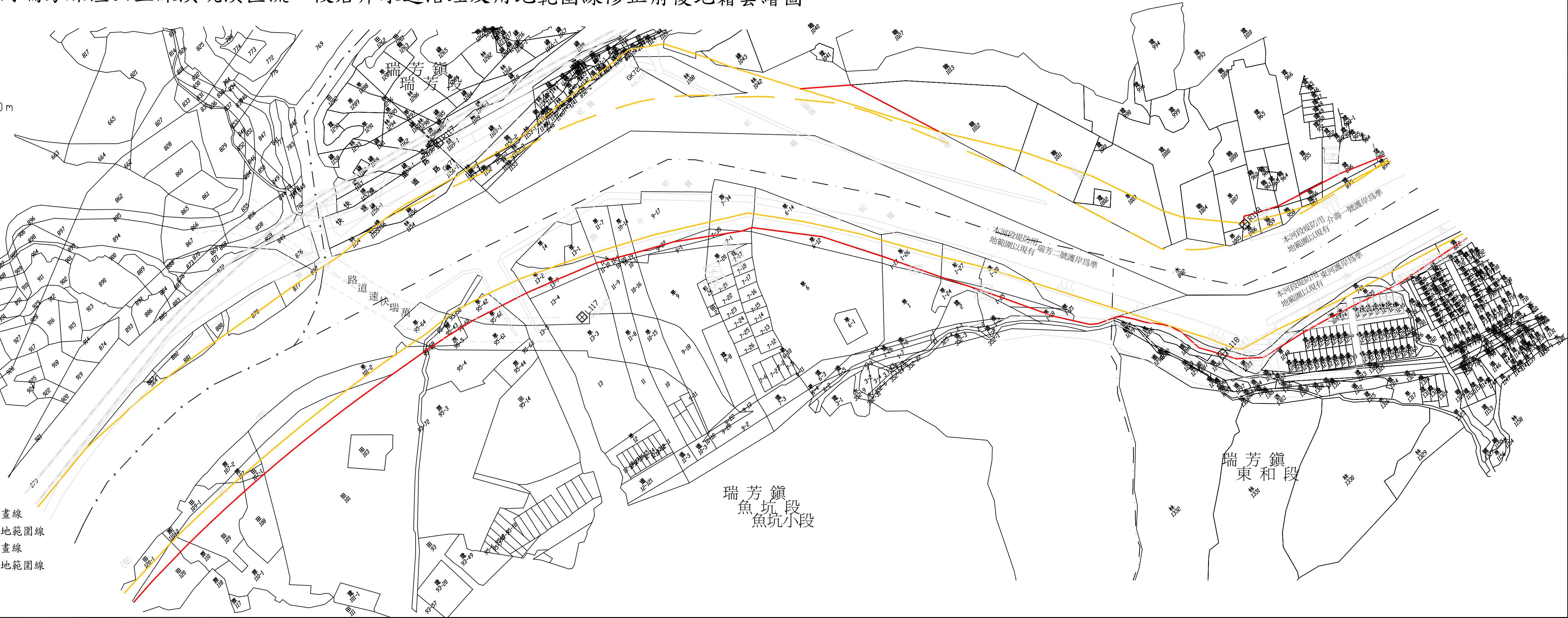
附圖2-5 基隆河瑞芳煤渣山至深澳坑溪匯流口段右岸水道治理及用地範圍線修正前後地籍套繪圖
