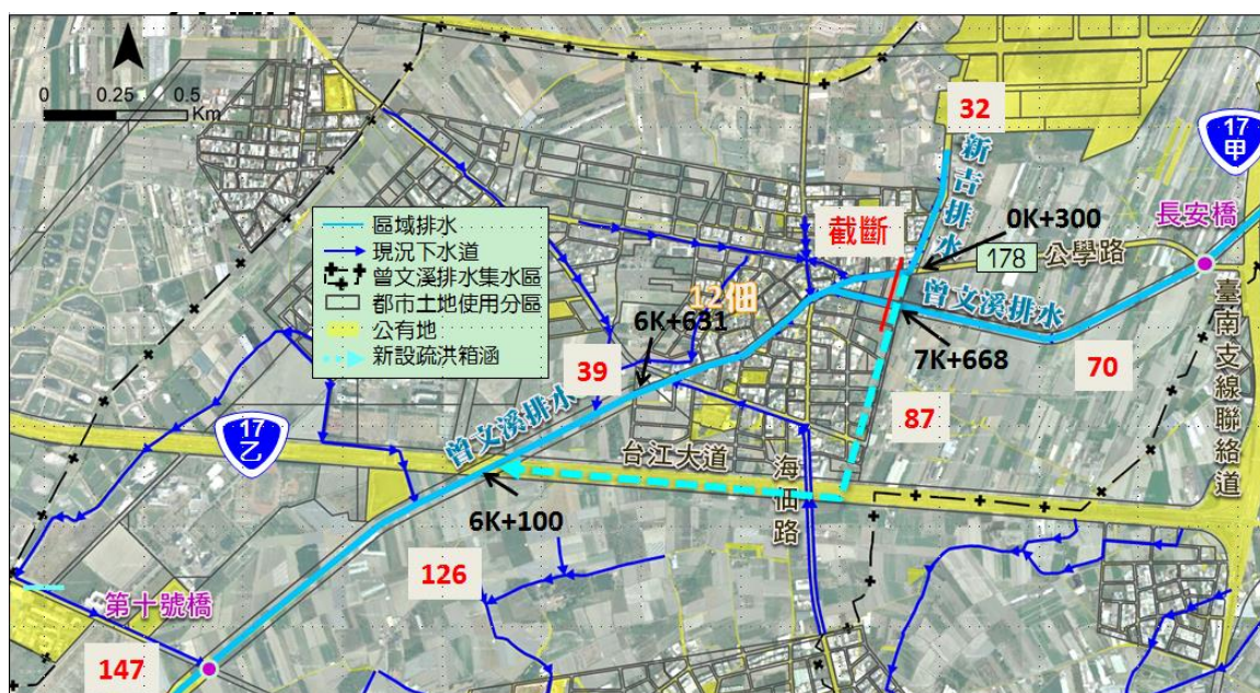
圖 5.2 新設疏洪箱涵流量分配及佈置圖
