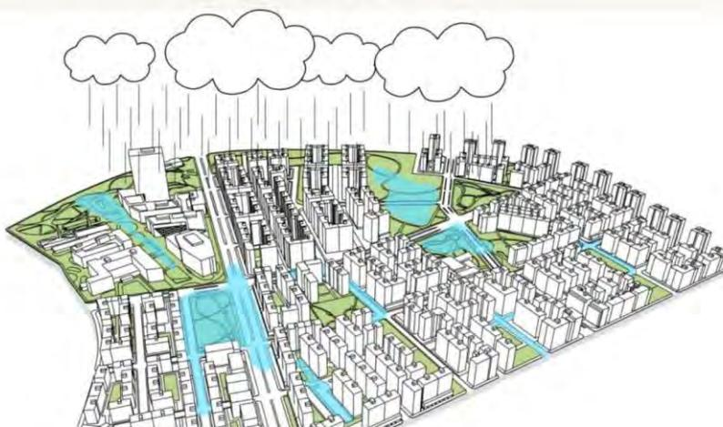
**極端降雨**超過下水道系統防洪頻率造成淹水
