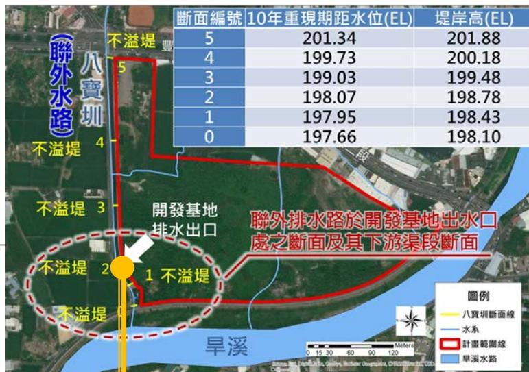
✓ 以水理模式檢核聯外排水路在與區域排水匯流口之外水位影響下之通洪能力
