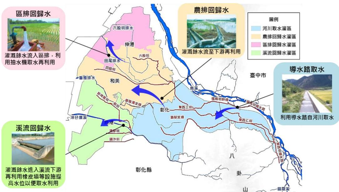
圖 15 農業灌溉用水在引水輸送與灌溉排水過程之回歸再利用特性
