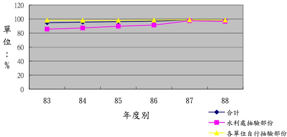
施工中工程混凝土鑽心取樣抽驗結果--件數統計圖
