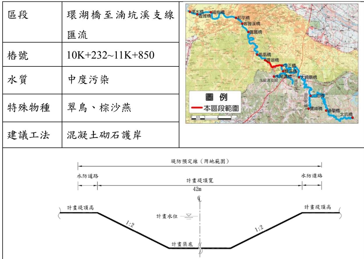
圖 9-7 環湖橋至湳坑溪支線匯流參考橫斷面示意圖
