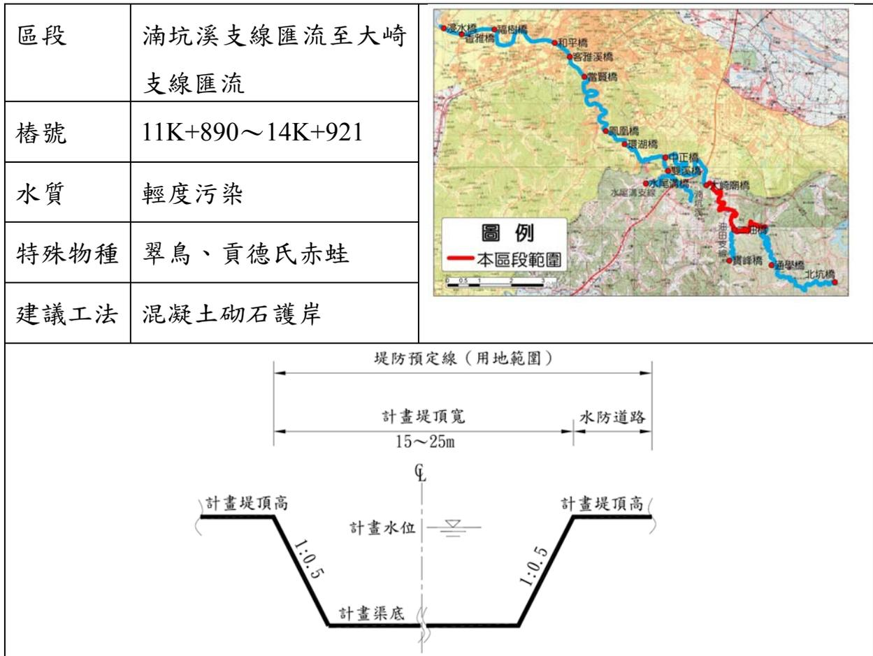
圖 9-9 大崎支線匯流至洽水支線匯流參考橫斷面示意圖
