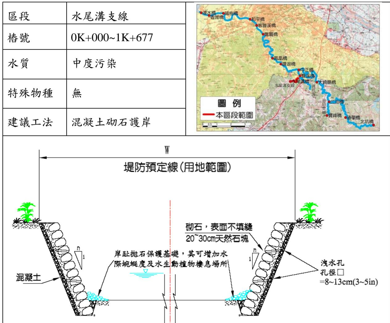
圖 9-15 水尾溝支線參考橫斷面示意圖
