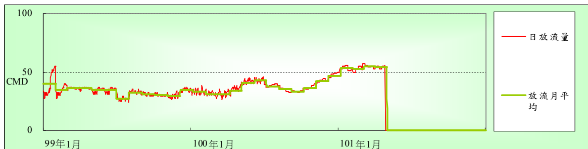
圖 5-10 信賢小型污水廠 99 至 101 年污水處理量 (因信賢小型廠辦理功能提昇汰換工程，故 5-12 月無資料顯示)
