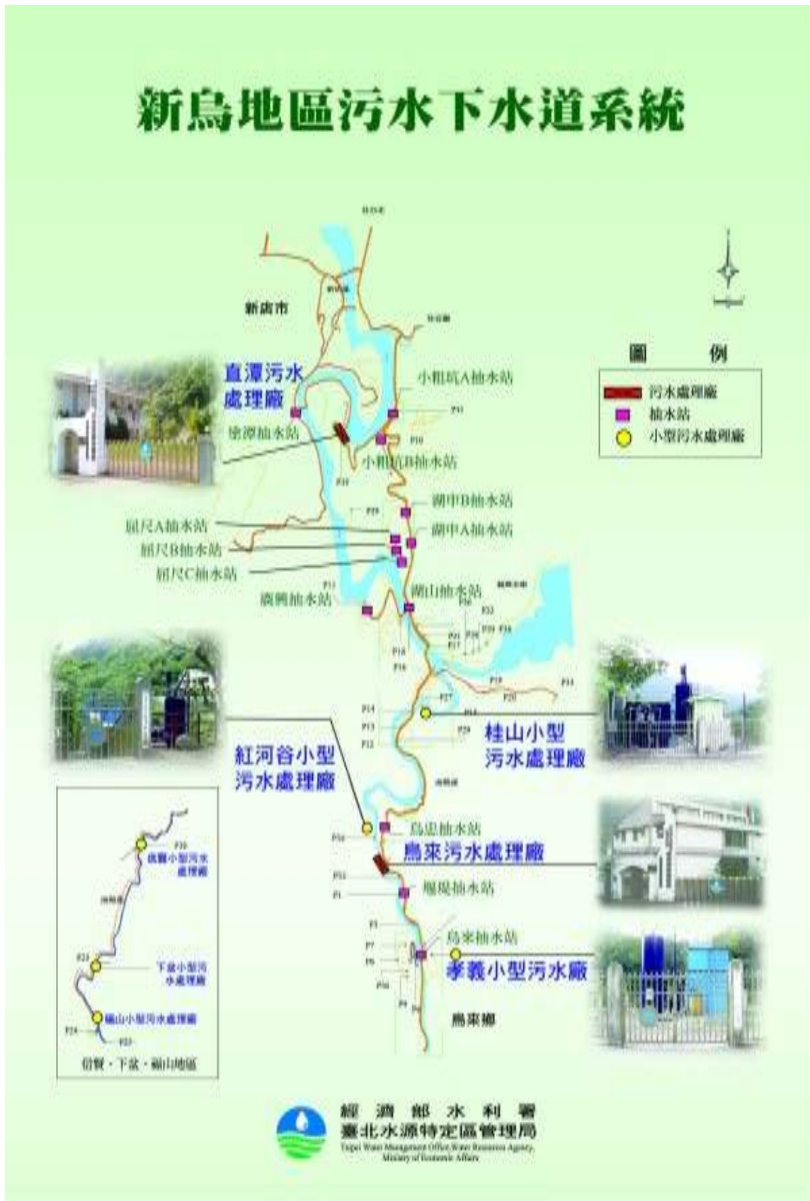
圖 5-5 新烏地區污水下水道系統及抽水站位置圖
