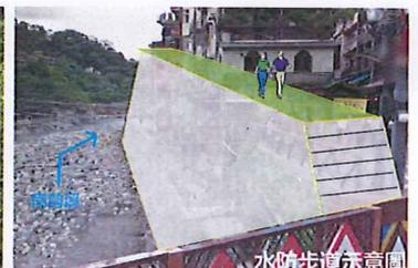
方案2：烏來觀光大橋改建(移除橋台)+施作直立式堤防+停車場段築土堤(烏來吊橋-斷面80)
