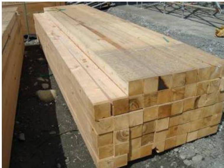
圖 125 角材因材質不同，強度差異大，設計時應考慮
