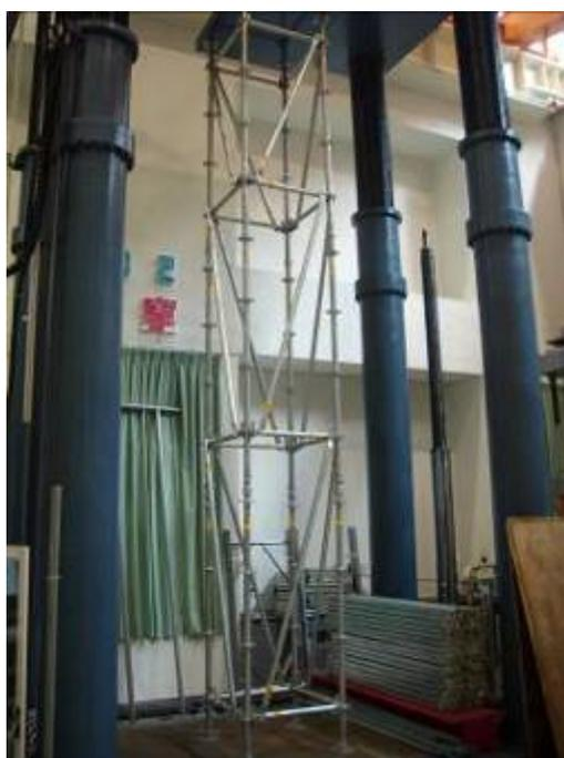
圖 118 三層系統支撐架組立圖
