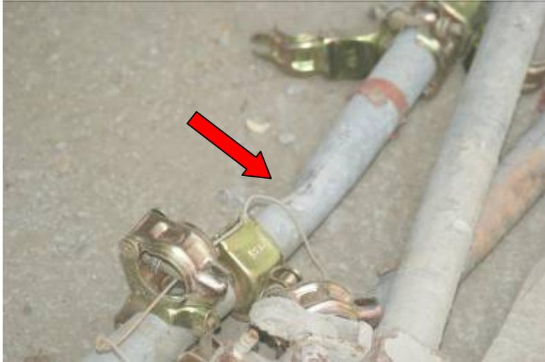
圖 66 鋼管支柱已發生變形
