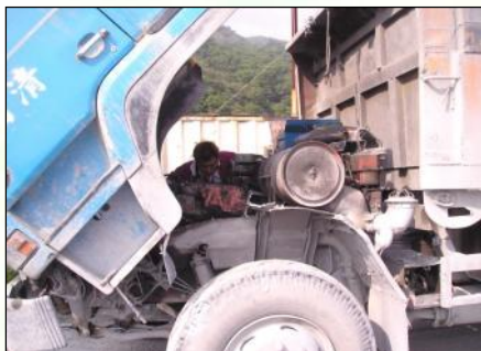
修車時開啟機件 □ 勞工有被夾之虞
