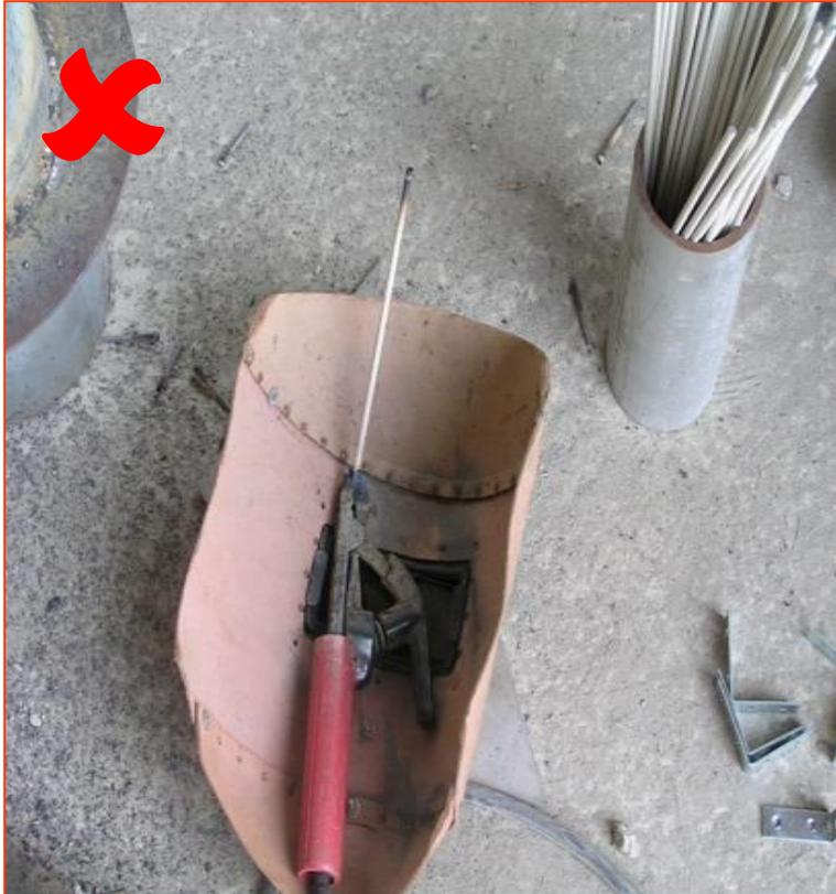
交流電焊機之焊接柄，部分絕緣被覆破損，增加勞工感電危險
