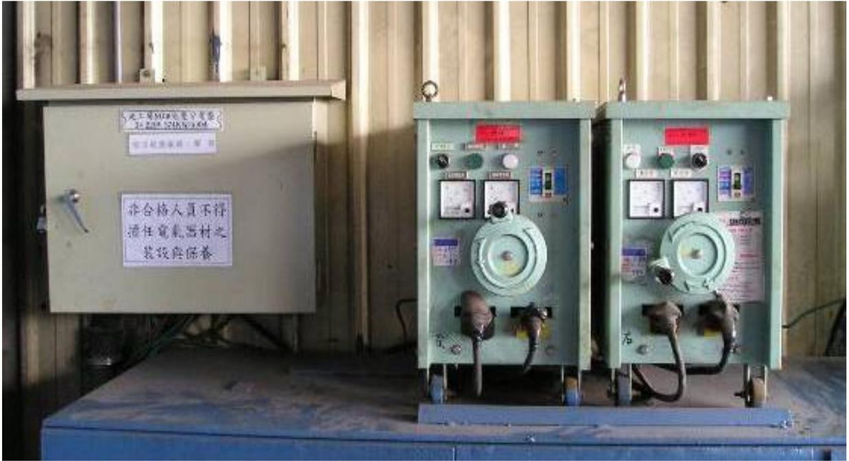
交流電焊機設置內藏式自動電擊防止裝置。
