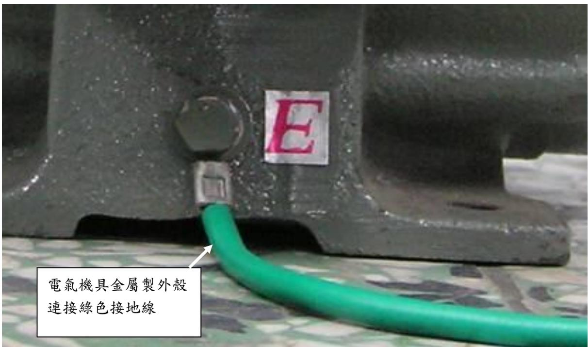
用電設備非帶電金屬部分實施接地。
