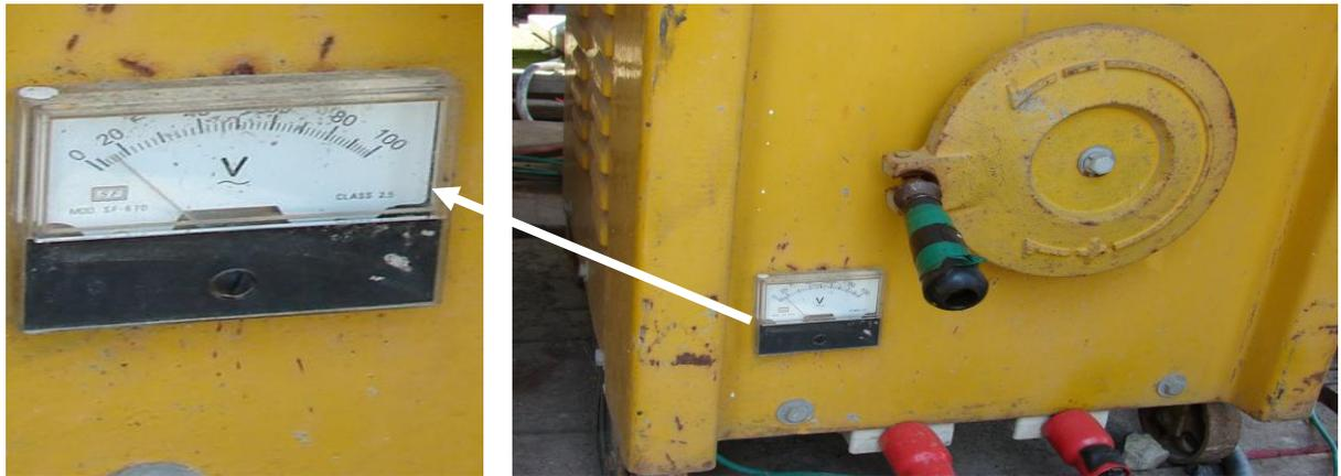
交流電焊機之內藏式自動電擊防止裝置設置電壓指示表。
