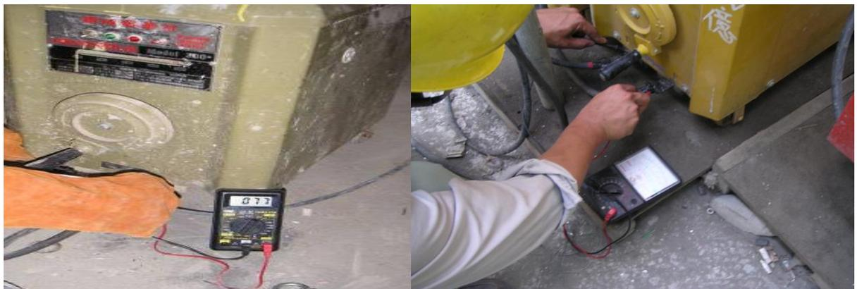
以攜帶式三用電表（多功能量測電表）測量交流電焊機二次側之電壓。
