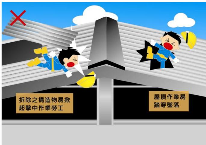
二、雇主對於高度 2 公尺以上之開口，勞工有遭受墜落危險之虞者，應於該處設置護欄、護蓋或安全網等防護設備，臨時性開口處使用之護蓋，表面漆以黃色並書以警告訊息。
