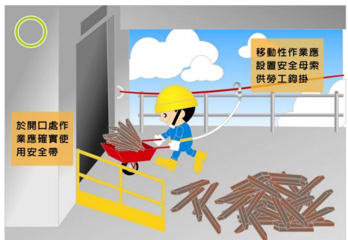
五、高度 2 公尺以上之模板組立作業，勞工有遭受墜落危險之虞者，應於該處設置護欄、護蓋或安全網等防護設備，雇主為前項設施有困難，或作業之需要臨時將護欄拆除，應採取使勞工使用安全帶等防止因墜落而致勞工遭受危險之措施。
